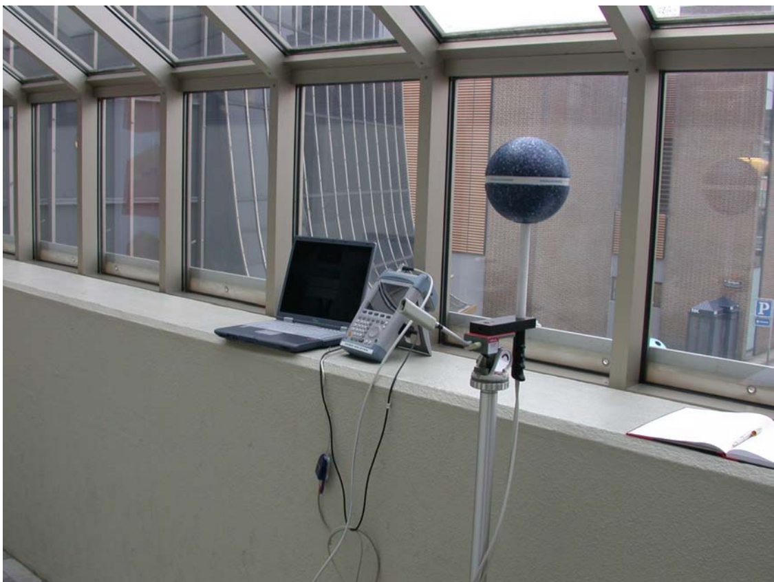
Laptop, spektrumanalysator og måleantenne
